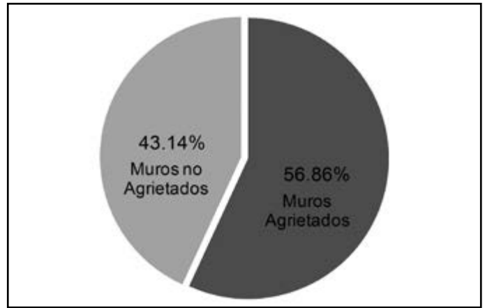
Figura 3. Porcentajes de muros afectados en la vivienda tipo.
