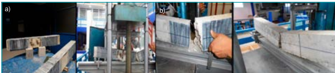
Figura 2. a) Viga reforzada y prueba a flexión. b) Modo de falla en viga reforzada y viga testigo.
