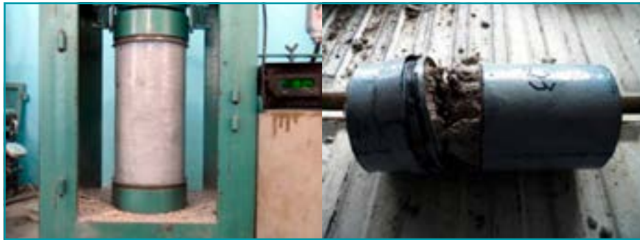
Figura 1. Prueba de compresión en cilindros y modo de falla.
