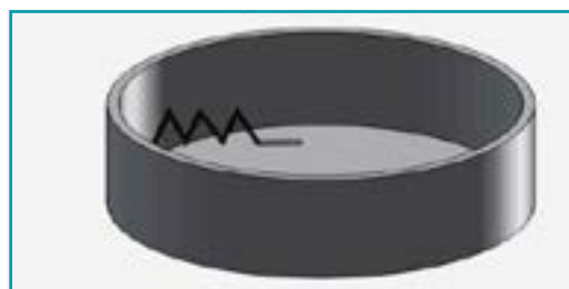
Figura 5. Sistema de calentamiento. Recipiente para agua suave con resistencia eléctrica sumergible indicada.
