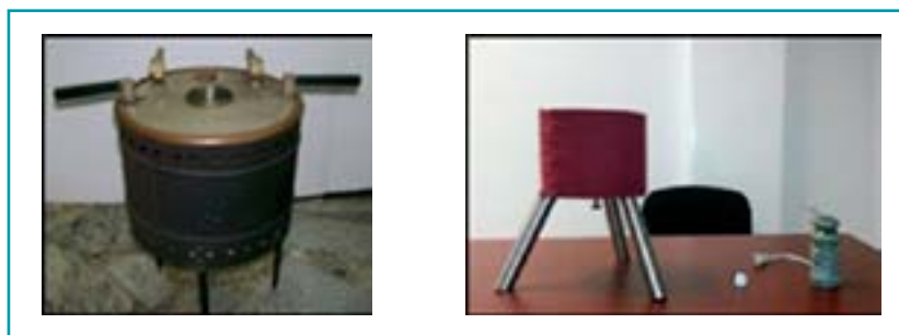
Figura 2. A la izquierda se presenta como ejemplo de un sistema Saybolt universal de línea. El equipo con que cuenta la Escuela Técnica General Manuel Savio, en Rosario, Argentina. A la derecha se muestra el Saybolt didáctico propuesto, diseñado y desarrollado en el ITA.
